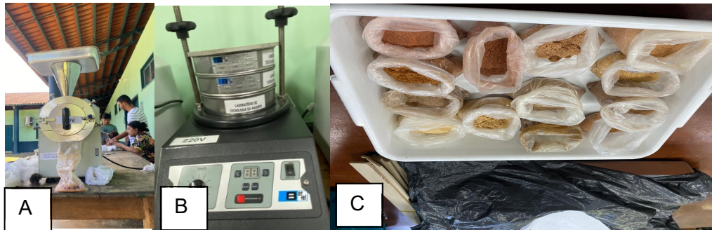
Figura 2. A: moinho Willey; B: Peneira 40 e 60 mesh e C: material peneirado de cada espécie.
